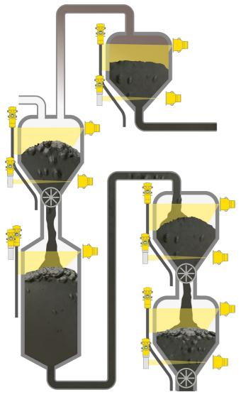
Mesure et détection de niveau Point de mesure Colonne verticale Plage de mesure jusqu'à 20 m Produit Naphta liquide Température process +230 ... +400 °C Pression process +20 ... +60 bar Défis spécifiques Température process élevée
