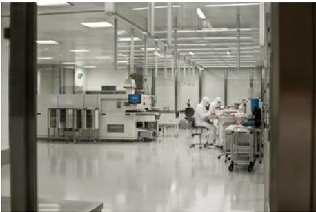
VEGA 在洁净室内加工陶瓷测量元件。
