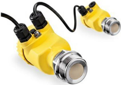
常规的差压测量采用的是差压变送器，测量元件通过引压管连接需要对比的两个测量点。然而，Robin Müller表示，这些引压管“会在实际应用中引起各种问题”。例如寒冷环境下，液体或冷凝水可能结冰，或者气体可能会进入管道，导致测量结果不准确。VEGA提出的解决方案，是采用两台独立工作的测量仪表，将它们用电缆连接，从而实现可靠精准的差压测量——完全不需要故障频发的引压管。
