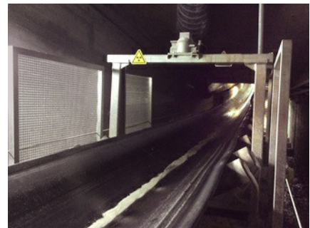
Le WEIGHTRAC 31 se monte sans problème sur un convoyeur existant. Comme il mesure sans contact, il ne pose aucun problème d'usure.
