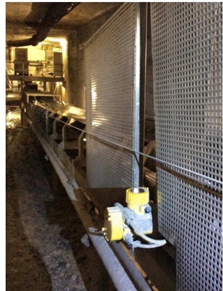
Le WEIGHTRAC 31 se monte sans problème sur un convoyeur existant. Comme il mesure sans contact, il ne pose aucun problème d'usure.
