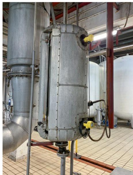
Los sensores VEGABAR 82 monitorizan la concentración de ácido tartárico, un componente importante de la grappa.
