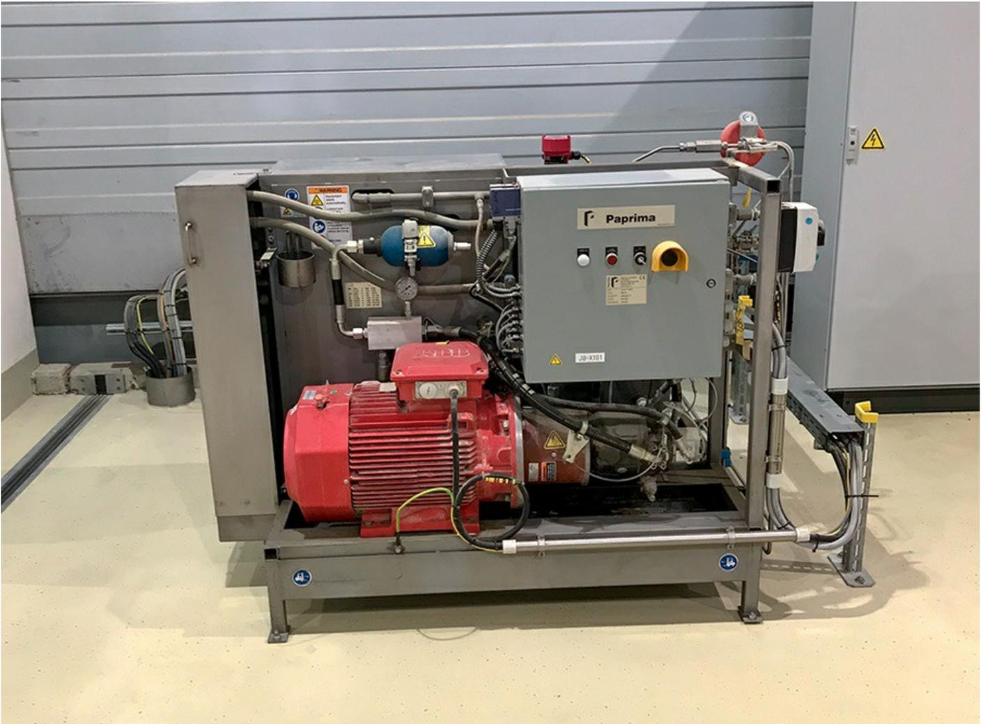
回转式活塞泵的润滑油的油位对运行很重要。幸亏使用了 VEGAPULS 64，得以实现可靠的油位测量。
