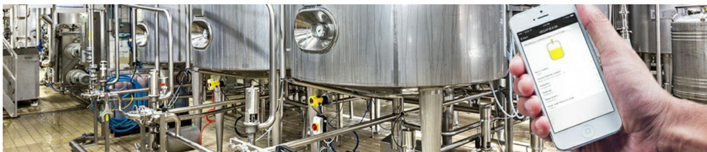
Il moderno e diffuso standard di comunicazione consente di eseguire la messa in servizio, la calibrazione, la visualizzazione dei valori di misura e la diagnostica con la massima comodità tramite smartphone o tablet. Le funzioni sono integrate nella app VEGA Tools gratuita e universale. Vale a dire che l'utente non necessita di diverse app per i diversi sensori e non deve eseguire l'aggiornamento del software del sensore. La struttura di calibrazione è sostanzialmente la stessa impiegata nel PC.
